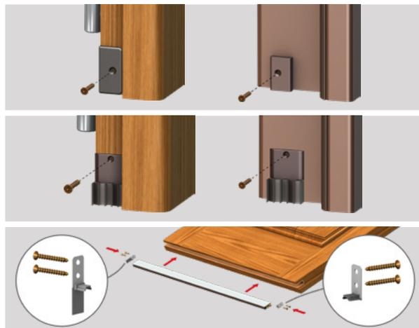
**PULSANTE (F):** esagonale in ottone, quadrato in nylon, smussato in nylon, rolling in nylon (pivot). **GUARNIZIONE:** tubolare in silicone, spazzolino.
