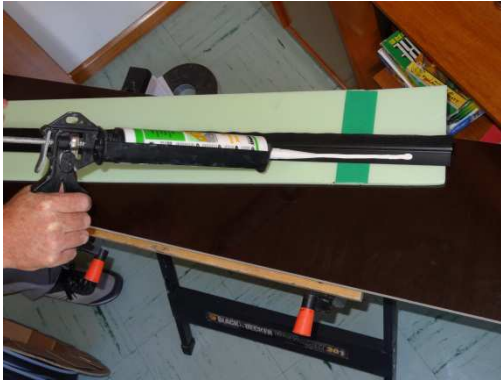
stendere l'MS polimero sul retro del portaspazzolino
